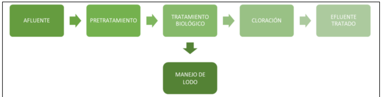
Imagen 4. Esquema de tratamiento de aguas residuales – San Antonio del Tequendama
