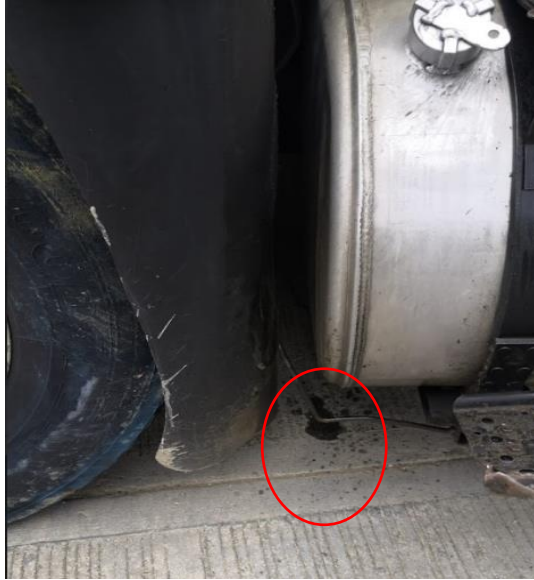
Imagen 39. Pérdida de líquido (ACPM) en el tanque de Combustible
