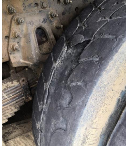
Imagen 40. Llantas del vehículo recolector en mal estado
