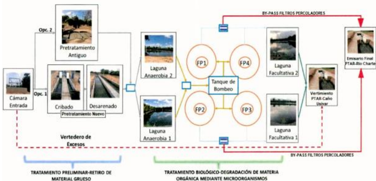
Imagen 23. Unidades de la PTAR existente
