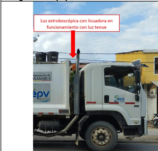
Imagen 74 Luz estroboscópica sobre la cabina con licuadora en funcionamiento con luz tenue.
