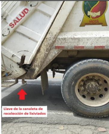
Imagen 66 Llave canaleta recolectora de lixiviados
