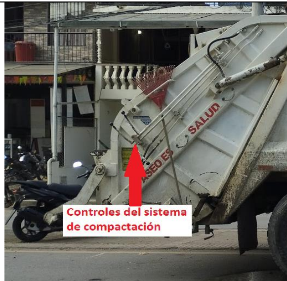
Imagen 70 Controles del sistema de compactación.
