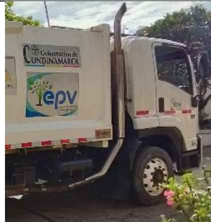
Imagen 67 Tubo de escape por encima de la altura máxima
