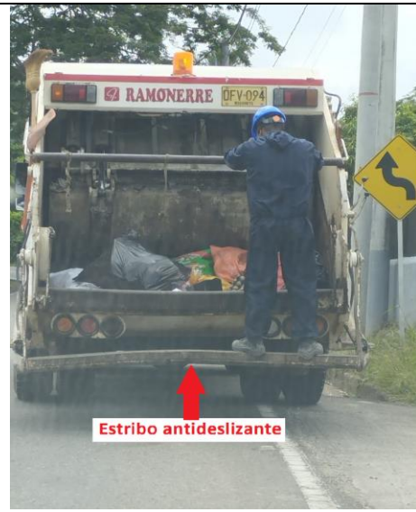
Imagen 71 Estribo antideslizante con deformación y manija en buen estado.
