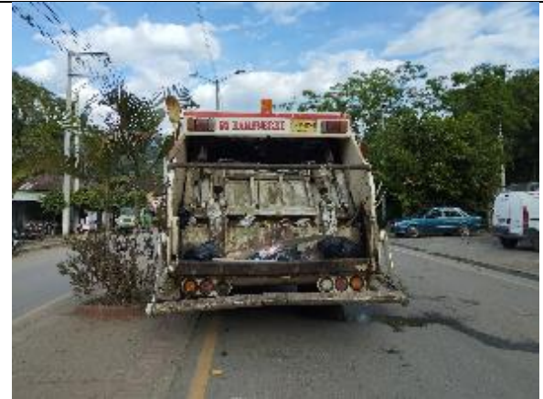
Imagen 69 Tubo de escape por encima de la altura máxima
