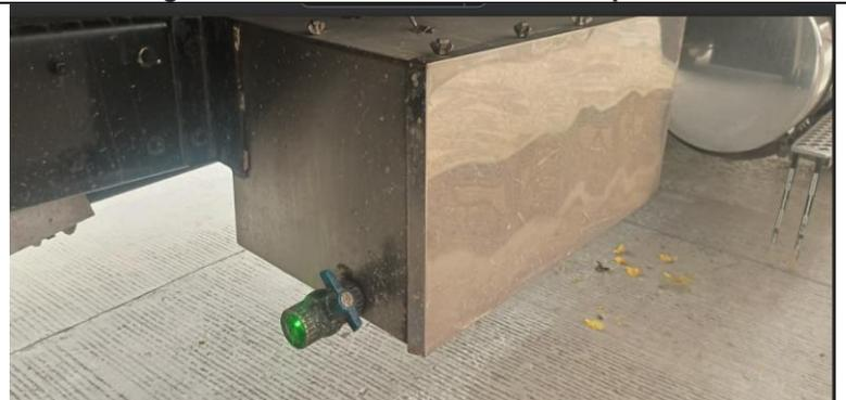
**Imagen 41. Caja de almacenamiento de líquidos lixiviados del compactador**
