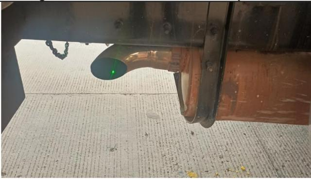
**Imagen 40. Tubo de escape por debajo de la carrocería**
