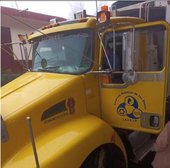
**Imagen 42. Balizas en la parte superior de la cabina del compactador**
