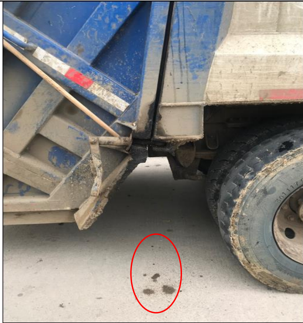
Pérdida de líquido (lixiviado)
