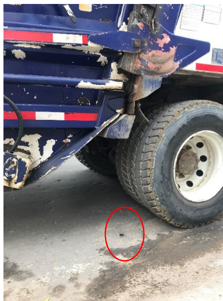
Pérdida de líquido (lixiviado)
