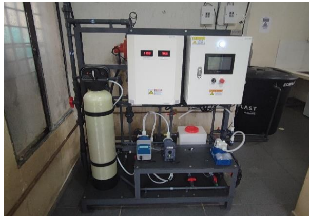
Imagen 11 Generador de cloro a partir de sal
