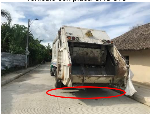
Imagen 15. Pérdida de líquido lixiviado vehículo con placa CRS 613
