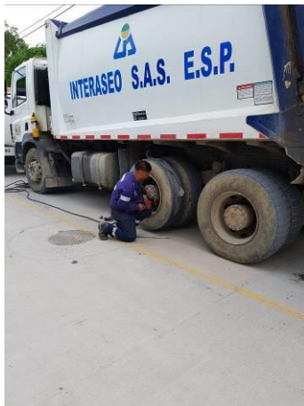
Ilustración 18. Medidas correctivas de la llanta en mal estado del vehículo de placas WEO 183. Fuente: Visita de inspección y vigilancia del 19 y 20 de septiembre de 2017
