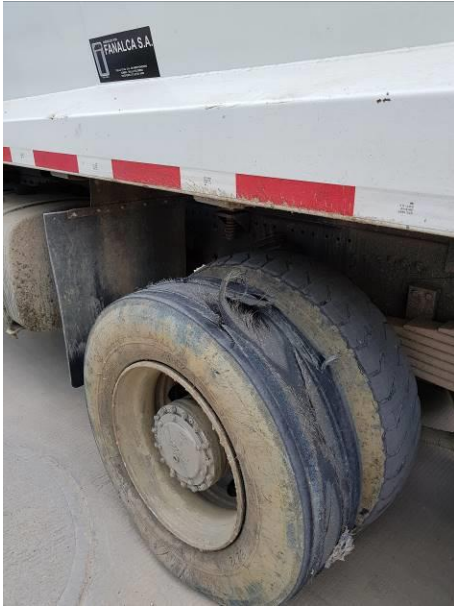
Ilustración 16. Llanta en mal estado del vehículo de placas WEO 183. Fuente: Visita de inspección y vigilancia del 19 y 20 de septiembre de 2017
