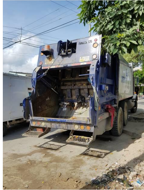
Ilustración 21. Derrame de lixiviados en el vehículo de placas WEL 959. Fuente: Visita de inspección y vigilancia del 19 y 20 de septiembre de 2017
