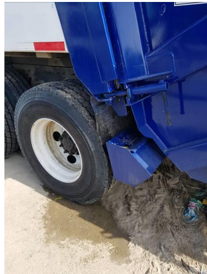
Ilustración 11. Derrame de lixiviados en vehículo de placas WEO 441 (verificación del miércoles 20 de septiembre). Fuente: Visita de inspección y vigilancia del 19 y 20 de septiembre de 2017
