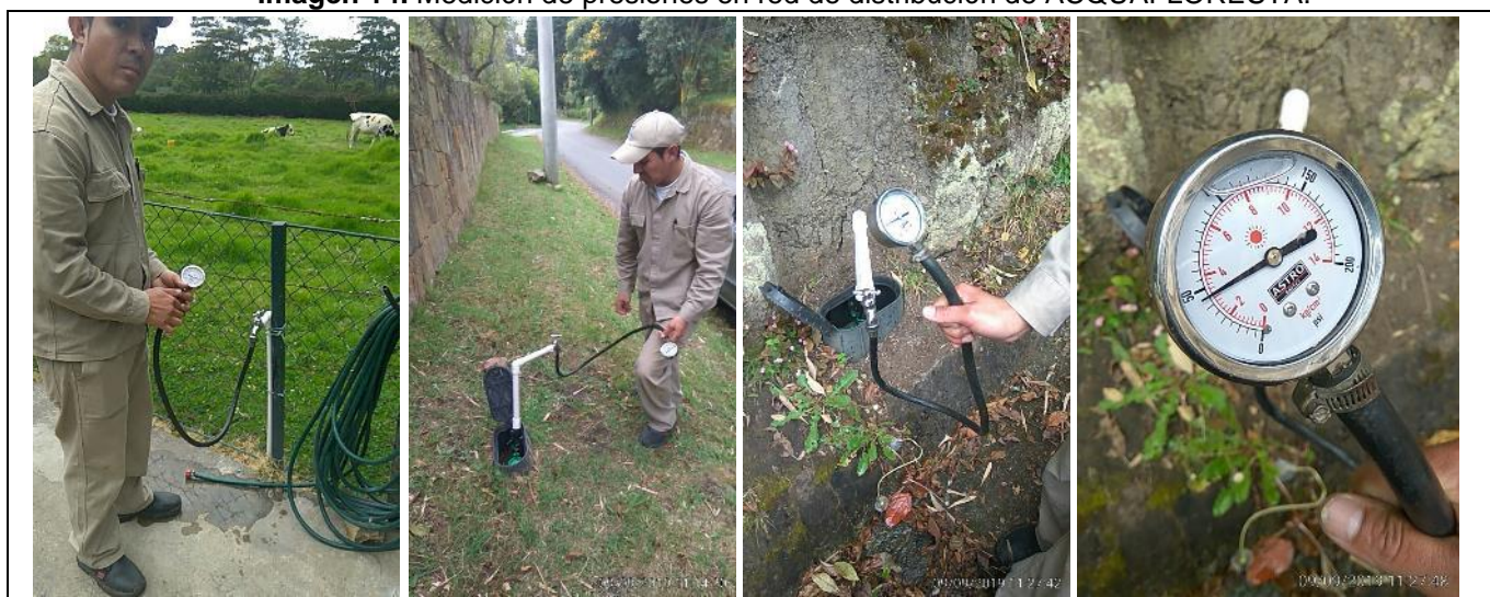
Imagen 14. Medición de presiones en red de distribución de ACQUAFLORESTA.
