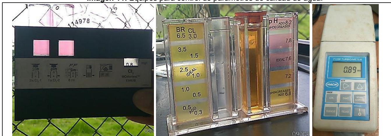
Imagen 11. Equipos para control de parámetros de calidad de agua.
