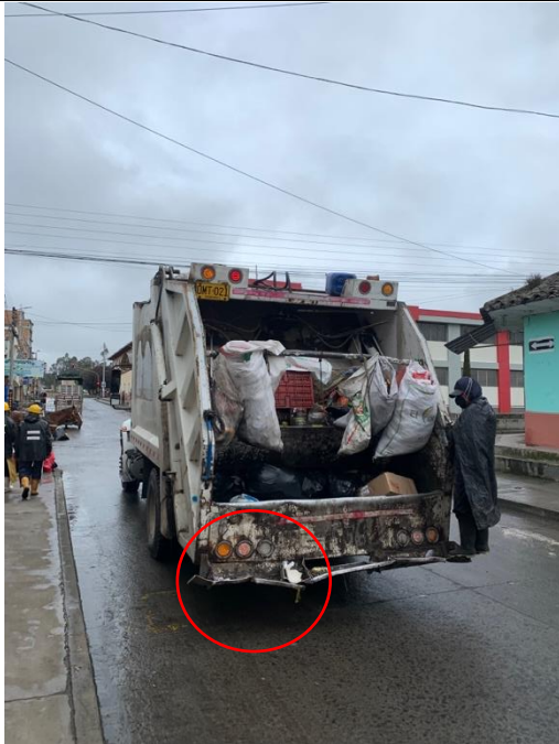
Vista trasera – estribo averiado
