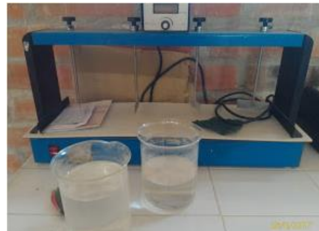
Foto 21 Equipo Ensayo de Jarras
