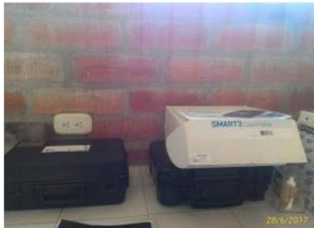
Foto 19 Equipos medición pH- Turbiedad
