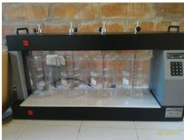
Foto 20 PTAP 2. Equipo Ensayo de Jarras
