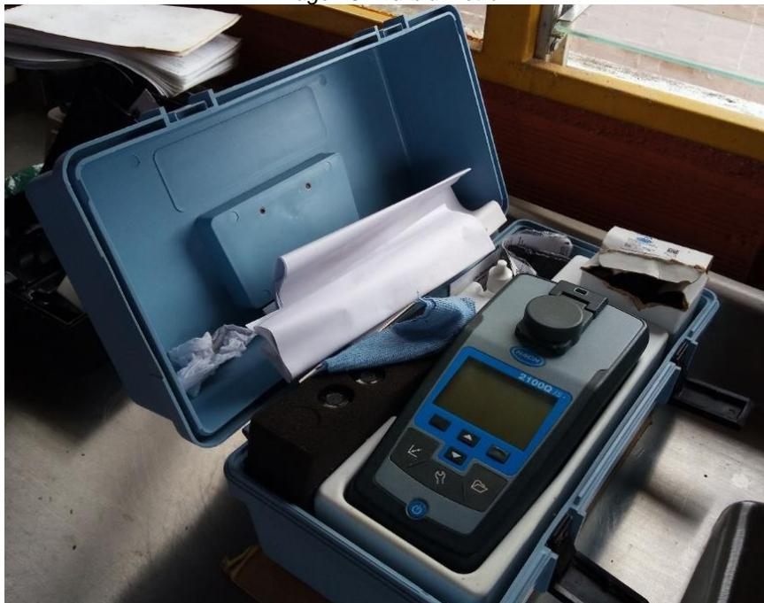
Imagen 33 Kit colorimétrico para medición de cloro residual y pH.
