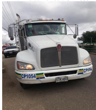
Imagen 39. Tubo de escape por debajo de la altura máxima del vehículo STK-683
