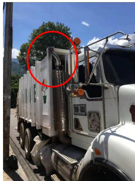
Foto 20. Compactador con placas TTS 321, se evidenció que la salida del tubo de escape no se encuentra por encima de la altura máxima.
