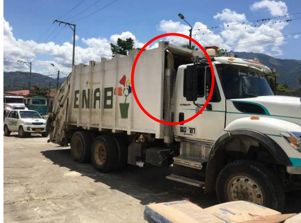
Foto 22. Compactador con placas SXS 787, se evidenció que la salida del tubo de escape no se encuentra por encima de la altura máxima.
