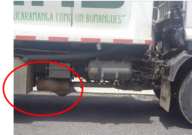
Foto 6. Compactador con placas SRS 390, se evidenció que la salida del tubo de escape se encuentra por debajo del vehículo.
