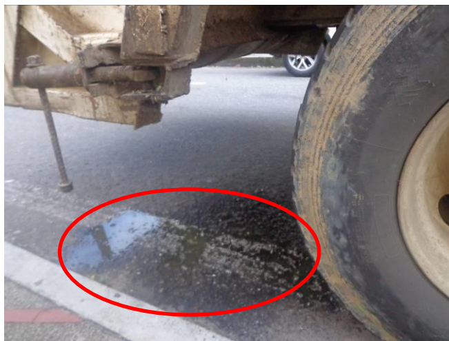
Foto 10. Compactador con placas CWM 559, se evidenció pérdida de líquido (lixiviado).
