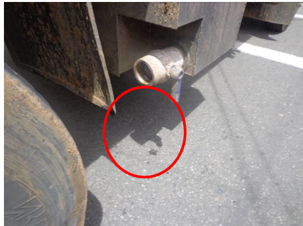
Foto 4. Compactador con placas SRS 409, se evidenció pérdida de líquido (lixiviado) en la llave del tanque de almacenamiento de lixiviados.
