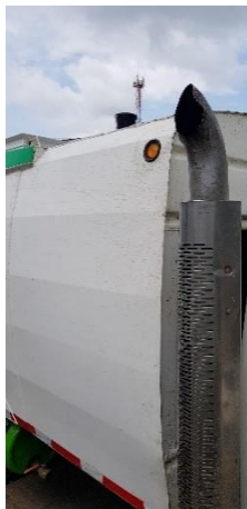
Ref. Tubo de escape por debajo de la altura máxima del vehículo
