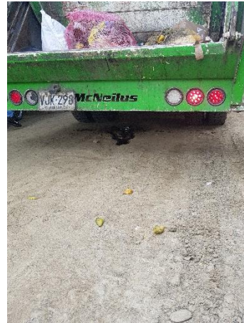
Ref. Fuga de líquido lixiviado
