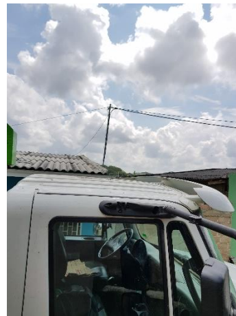
Ref. Ausencia de luz estroboscópica sobre la cabina
