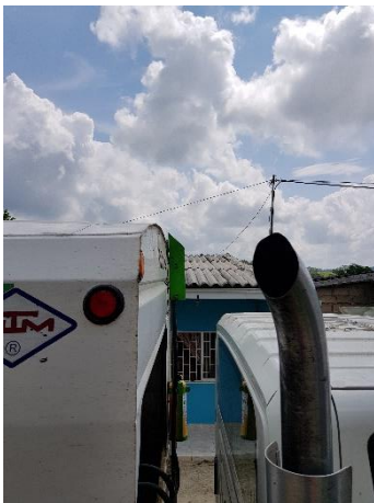
Ref. Tubo de escape por debajo de la altura máxima del vehículo
