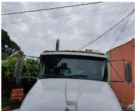
Ref. Ausencia de luz estroboscópica sobre la cabina
