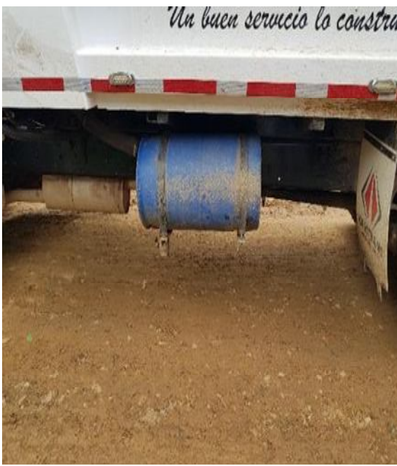
Ref. Tanque de almacenamiento de lixiviados
