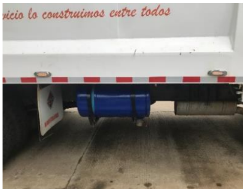
Ref. Tanque de lixiviado
