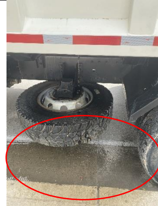
Pérdida de lixiviado
