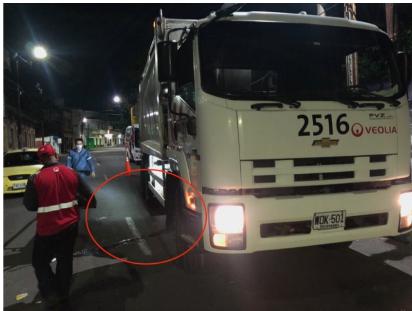
Imagen 31. Pérdida de líquido (lixiviado) vehículo placas WOK501
