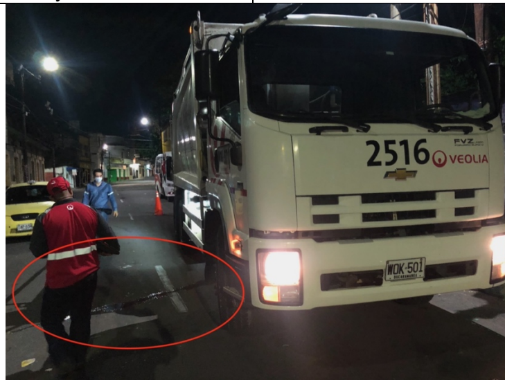
Pérdida de líquido (lixiviado)
