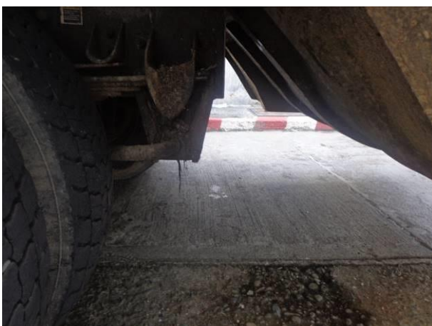
Ilustración 19. Pérdida de lixiviado en vehículo de placas TUN 484. Fuente: Visita de inspección y vigilancia del 18 y 19 de mayo de 2017
