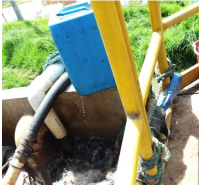
Ilustración 61. Adición de coagulantes. Fuente: Visita de inspección y vigilancia del 30 de junio de 2017.
