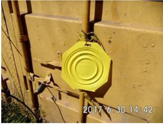
Ilustración 37. Instalación de platillo de monitoreo en container del campamento de Zona 8. Fuente: UNIÓN TEMPORAL INTER DJ
