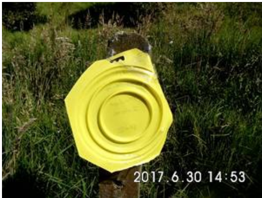
Ilustración 39. Instalación de platillo de monitoreo en la Vía El Broche. Fuente: UNIÓN TEMPORAL INTER DJ
