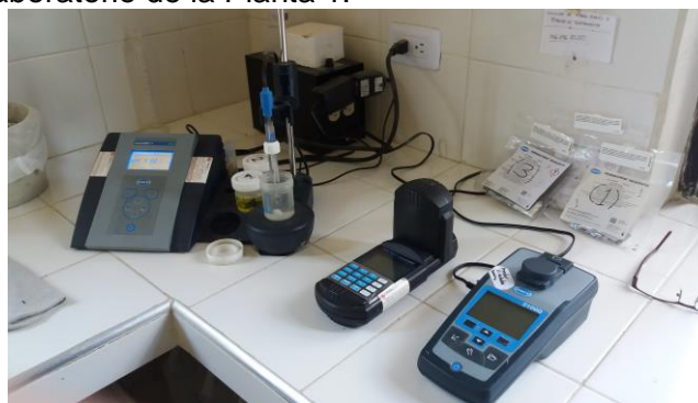
b) pHmetro, turbidímetro y colorímetro.
