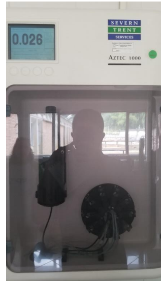
Medición en línea de manganeso
