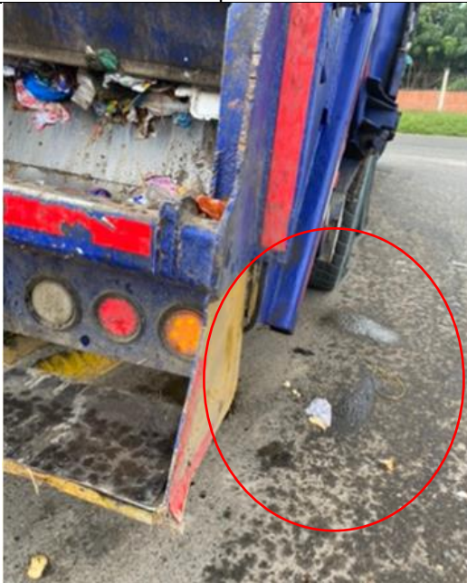
Pérdida de lixiviado en la inspección
