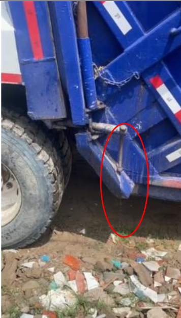
Pérdida de lixiviados
