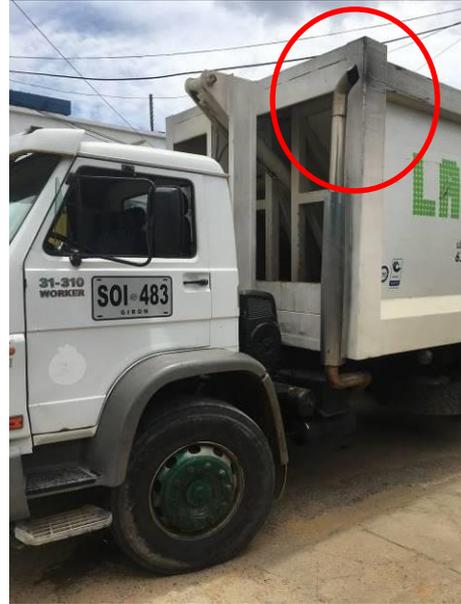
Imagen 17. Compactador con placas SOI 483, el cual fue verificado el 29 de junio de 2017, el tubo de escape no se encuentra por encima de su altura máxima.
