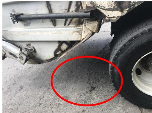
Foto 6. Perdida de líquido lixiviado Vehículo con placa KUM 917
