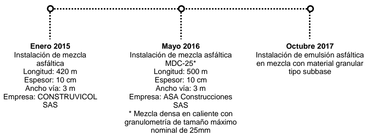
Figura N° 2. Línea de tiempo de las actividades ejecutadas para la adecuación de las vías secundarias
